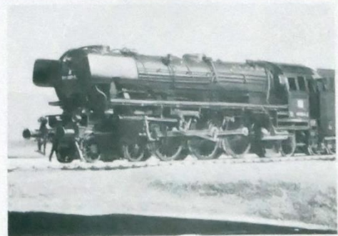
+ 3101 Schnellzuglok BR 01 16 (011), schwarz 3zyl. Triebwerk
