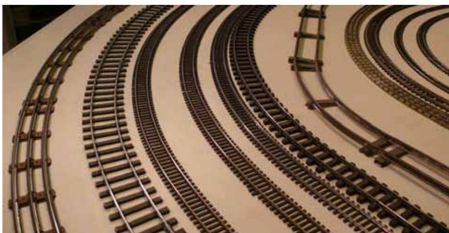
Un réseau pluri-écartements. De gauche à droite : 0 en 3 rails, 0 en 2 rails, 2 circuits en HO 2 rails, HO 3 rails (Märklin), S, 0 mécanique, 00 en 3 rails, HO 3 rails (Trix), N, HOe
